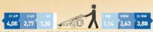
Grafico velocità in km/h con ruote 5.0-10 / Graphique des vitesses en km/h avec des pneus 5.0-10
