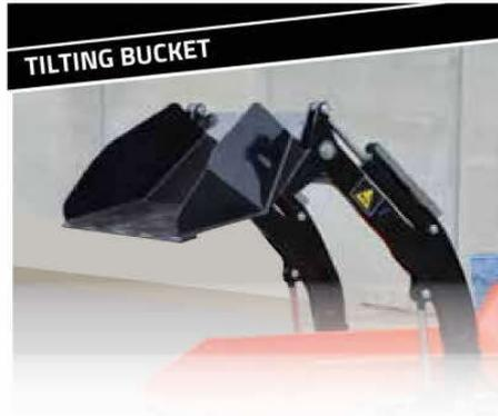
フロントバケットは上下に動くスイベル式で、荷積みのみならず前方へのダンプ操作も、押しブルの用に使用することも可能です
